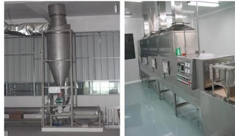
③ 干燥灭菌：全自动气流烘干机，省略人工刮片、晒制过程中繁琐的步骤，节约成本；自动化食品灭菌设备，避免二次污染让您吃得更健康。
