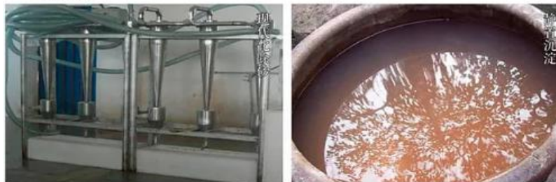
② 沥浆：粗略获得的藕浆经过除去浮粉等杂质之后，需要经过至少一宿的沉淀（根据藕浆的量确认），将水倒掉藕浆倒入除砂机中除砂，这样保证藕粉的口感质地细腻。
